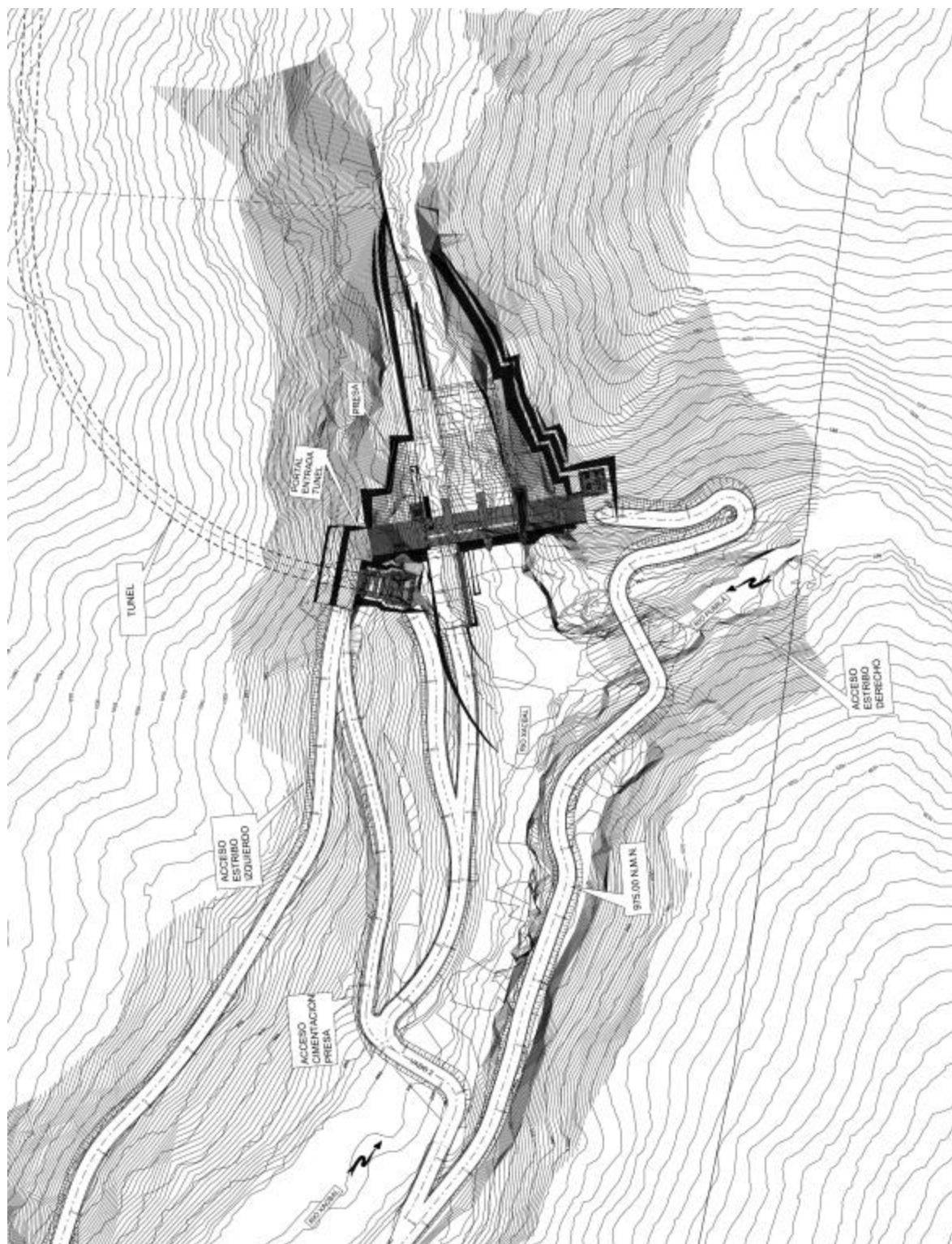
Fig. 2.7 Rutas de acceso a presa y obra de toma (sólo la vía izquierda se encuentra habilitada, las otras son con el Embalse vacío).
